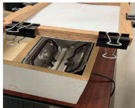
Figura 2. Caja térmica con resistencias eléctricas para ablandar la lámina de estireno.
