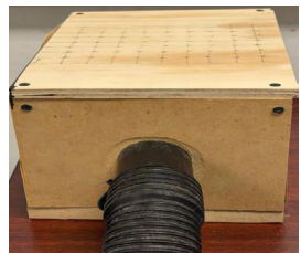
Figura 3. Cámara de vacío conectada a una aspiradora de 6 galones para aplicar succión durante el termoformado.
