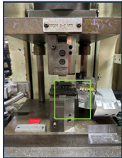
Fig. 4. Se remueve exceso de base donde topaba el tubo al remachar
