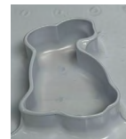
Figura 5. Pieza termoformada de estireno obtenida tras la aplicación de vacío, mostrando la reproducción completa del contorno del molde.
