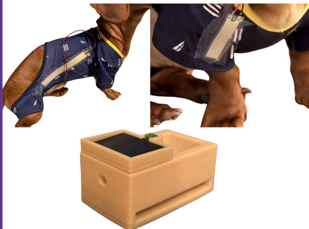
Figura 2. Arnés para sujetar los sensores y la electrónica de recolección de energía.
