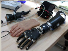
Figura 1. Prótesis de brazo robótico controlada por el pensamiento [3]
