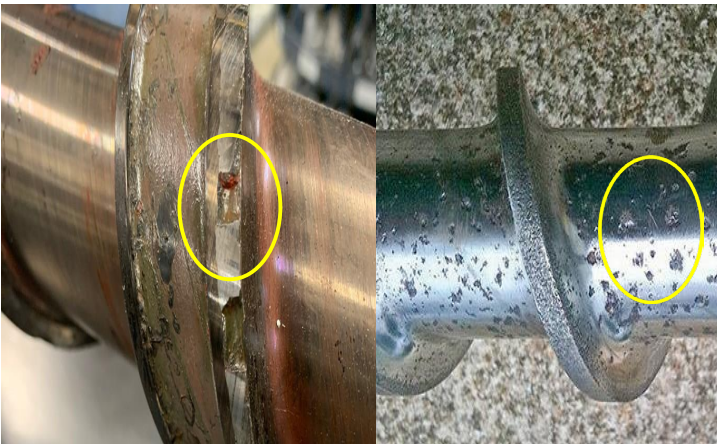
Fig.2 Deterioro en husillo
