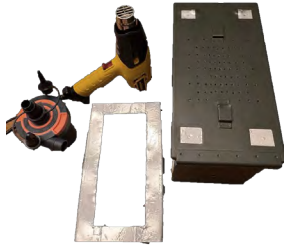
Figura 1. Elementos de la máquina de termoformado
