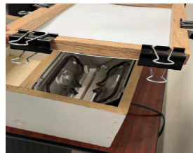
Figura 2. Caja térmica con resistencias eléctricas para ablandar la lámina de estireno.
