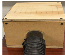
Figura 3. Cámara de vacío conectada a una aspiradora de 6 galones para aplicar succión durante el termoformado.
