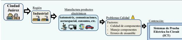
La prueba In-Circuit (ICT) consiste en aplicar evaluaciones eléctricas a cada uno de los componentes que conforman una tarjeta electrónica [1]. Este procedimiento permite verificar el cumplimiento de las especificaciones técnicas y de las tolerancias eléctricas definidas, lo que asegura la integridad de los elementos ensamblados y, en consecuencia, el correcto desempeño del producto final [2].
