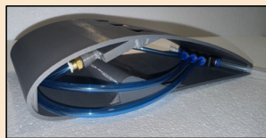
Fig. 7. Configuración de alimentación de flujo en osciladores de flujo dentro del perfil aerodinámico.
