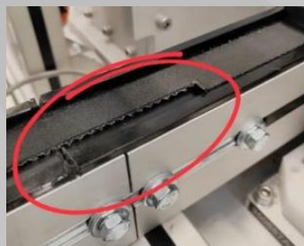
Fig. 3 Daño en banda de conveyor
