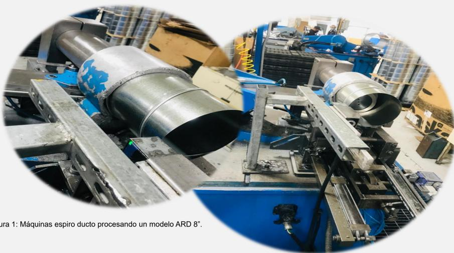
Figura 1: Máquinas espiro ducto procesando un modelo ARD 8".
