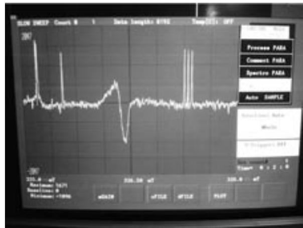
Figura 3. Espectro que arroja la lectura por EPR donde se obtiene la cantidad de radicales libres midiendo en unidades arbitrarias la altura del espectro.
