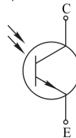
Fig. 7. Símbolo eléctrico de un fototransistor
