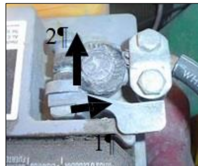
Fig. 3. Posicionamiento de terminal.
