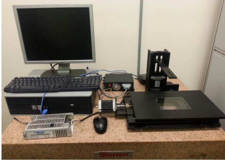
Figura 4: Integración de máquina de medición por coordenadas en dos dimensiones
