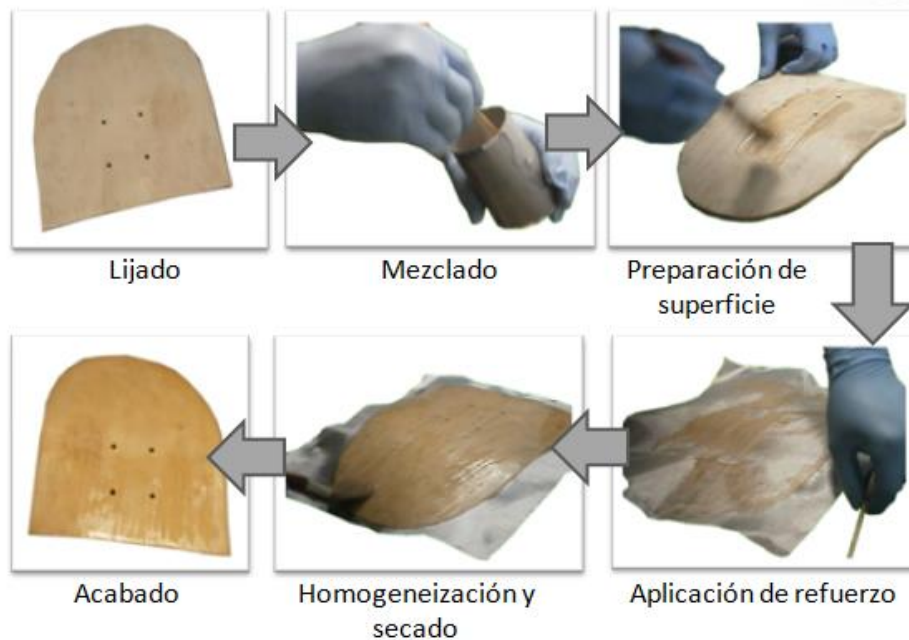
Figura 15: Método de refuerzo para las tablas de patinar.
