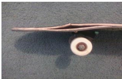
Figura 22: Delaminación de un tabla
