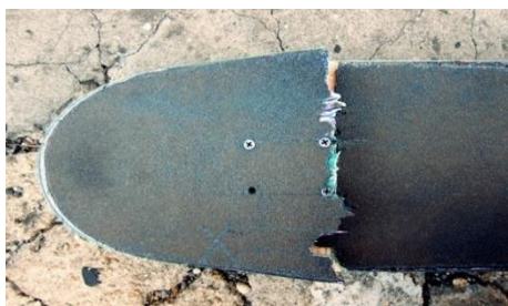
Figura 23: Fractura por eje
