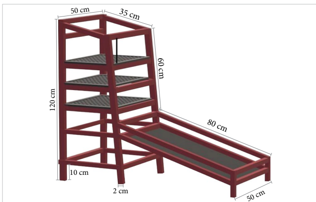
Figura 3. Diseño inicial de un prototipo deshidratador base metálica con medidas elaborado por un equipo.
