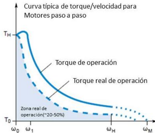
Figura 3: Curvas típicas de torque/velocidad
