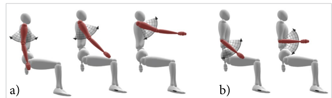
Figura 3. Método postural RULA. Posiciones a) del hombro y b) del brazo. Recuperado de [18].
