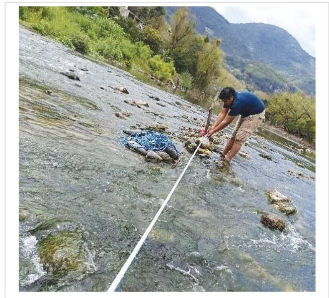
Figura 2. Medición de profundidad y ancho del río.
