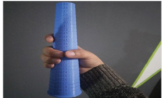
Figura 4. Cono de medición de empuñadura ErgoTech Mx.
