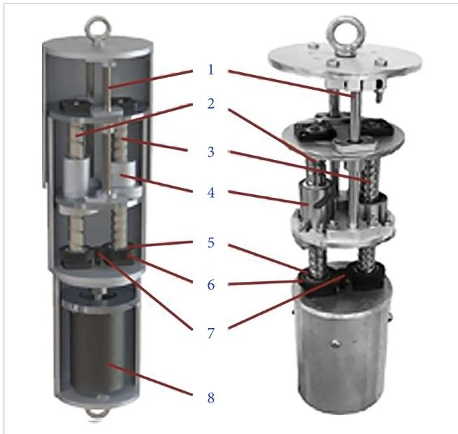
Figura 8. Amortiguador regenerativo electromecánico basado en doble transmisión de tornillo-bola: 1) vástago del amortiguador, 2) tornillo izquierdo, 3) tornillo derecho, 4) tuerca del tornillo, 5) embrague unidireccional, 6) engrane, 7) piñón y 8) generador eléctrico [55].
