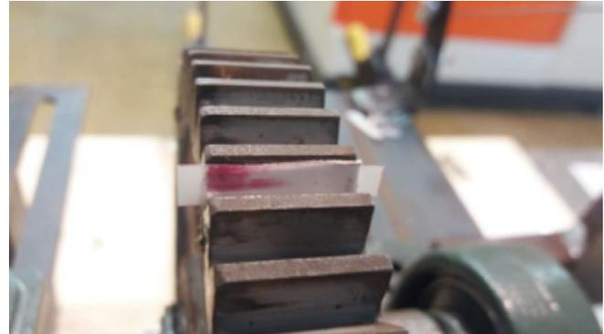
Figura 2. Colocación de película de presión.
