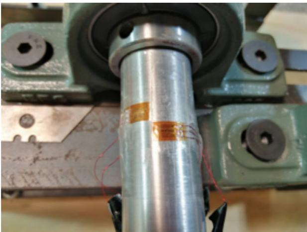
Figura 5. Colocación de galgas para la medición del torque.
