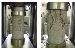
Figura 2. Revisión de la resistencia a compresión de los cilindros de concreto
