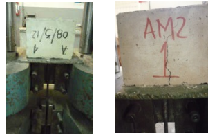
Figura 4. Extracción de una varilla embebida en un cubo de concreto
