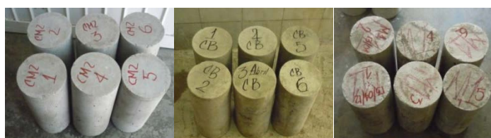
Figura 1. Lotes de cilindros blanco y con contenido de carbonato de magnesio \text{MgCO}_3
