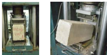
Figura 6. Determinación de la resistencia a flexión de una viga de concreto simplemente reforzada
