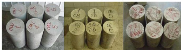
Fig. 1. Lotes de cilindros blanco y con contenido de carbonato de magnesio  $\text{MgCO}_3$
