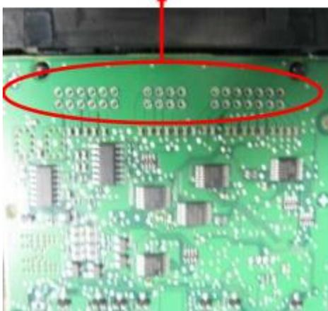
Terminales de conector después de ser soldadas
