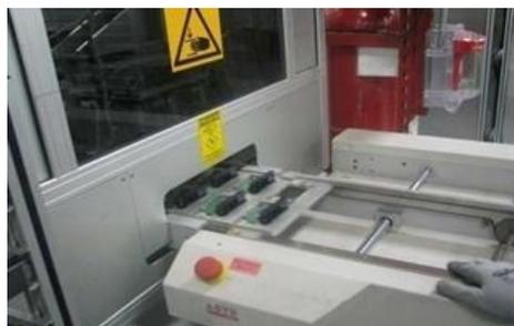
Fig. 2. Pallet de 8 PCB's entrando a soldadora selectiva
