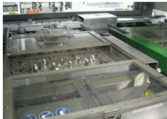
Fig. 5. Contenedor de soldadura con boquillas
