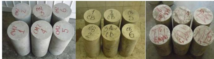
Figura 1. Lotes de cilindros blanco y con contenido de carbonato de magnesio  $\text{MgCO}_3$
