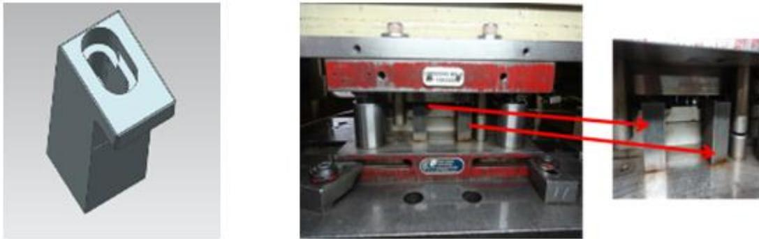
Figura 9. Sistema de sujetadores troquel 13833340 MA 1
