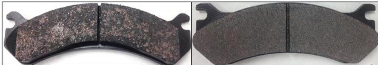
Figura 15. Izq. Pieza Defectuosa (2 Mezcladoras) – Der. Pieza Aceptable (1 Mezcladora)
