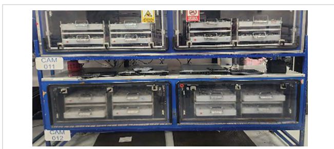
Figura 1. Equipo de prueba eléctrica para prueba de alarmas de CO y gas explosivo.
