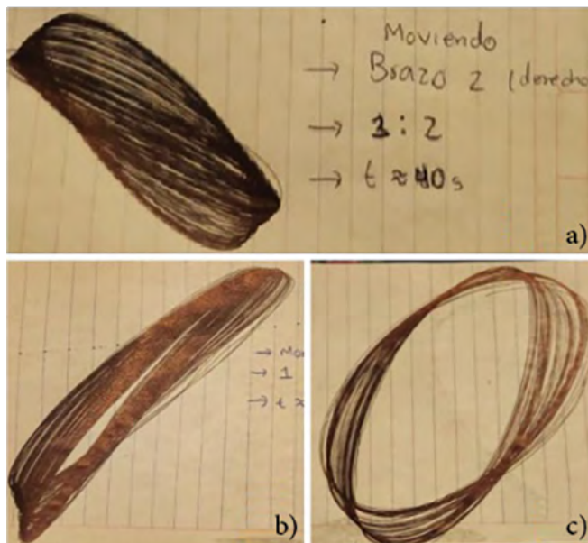
Figura 6. Tres figuras de Lissajous generadas utilizando el prototipo III. En el inciso a) se detallan las especificaciones de frecuencia y tiempo. Con el permiso del autor.
