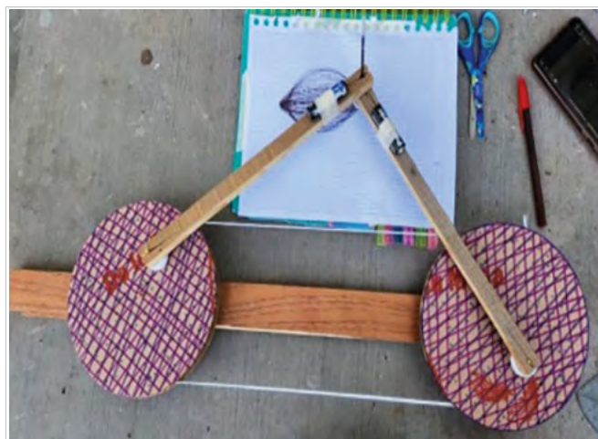
Figura 5. Prototipo de armonógrafo: oscilador armónico en 2D, placas giratorias acopladas por una cuerda. En la parte superior se observa el dispositivo que sostiene perpendicularmente un plumón. Con el permiso del autor.
