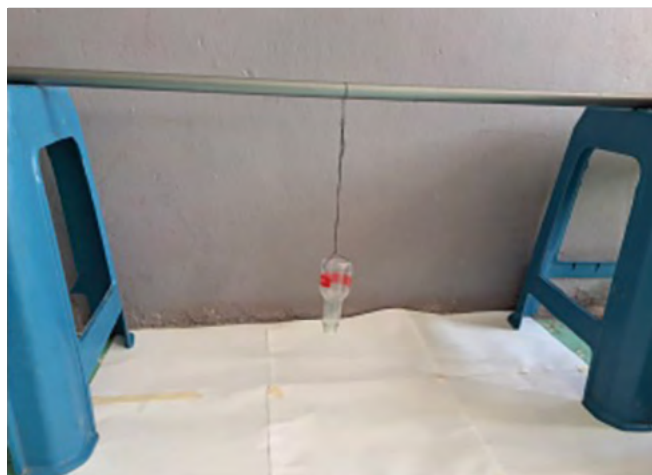
Figura 3. Prototipo de oscilador simple, la masa del péndulo está representada por una botella con pintura diluida y que cuelga de un hilo sostenido de un tubo o palo. En el piso se observa un material donde se imprimen las figuras dependiendo del ángulo que se le dé al péndulo. Con el permiso del autor.
