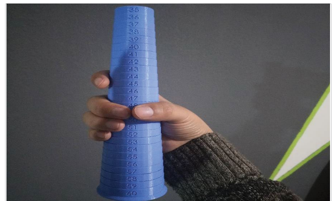
Figura 4. Cono de medición de empuñadura ErgoTech Mx.
