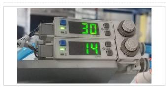
Figura 9. Perillas de control de flujo para cautines superior e inferior. Fuente: los autores.
