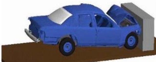
Figura 2 Análisis de colisión frontal a un vehículo Ford Crown Victoria
