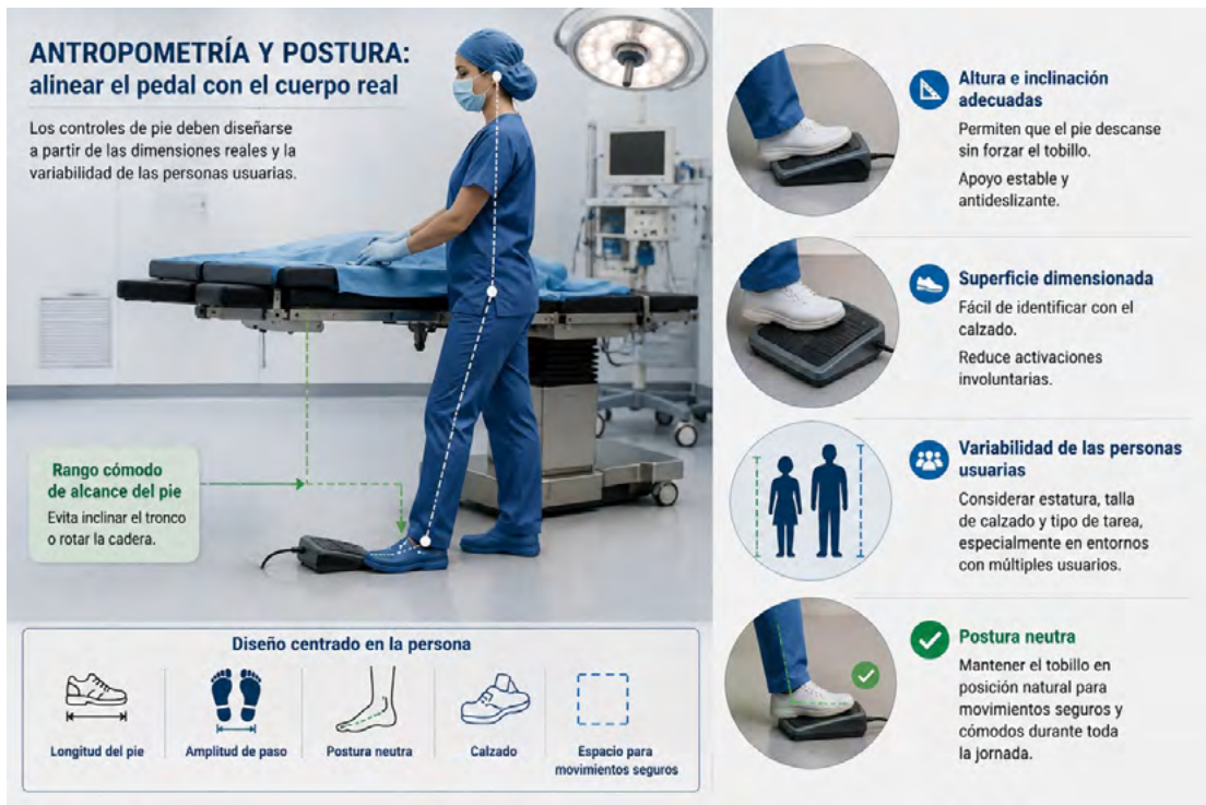
Figura 1. Principios ergonómicos para la ubicación y el diseño de un pedal médico de control.
