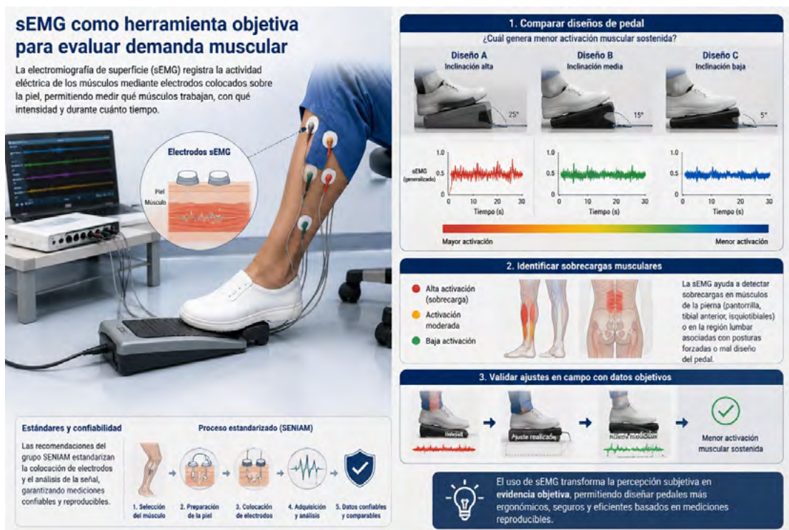
Figura 2. Evaluación de la demanda muscular mediante electromiografía de superficie durante el uso de un pedal médico.
