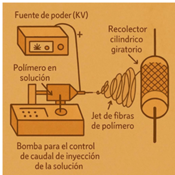
Figura 2. Esquema representativo de los principales componentes de un equipo de electrohilado.
