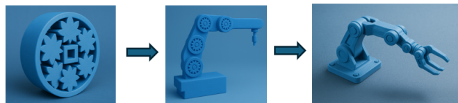
Figura 3. Rodamientos en manufactura aditiva como articulaciones robóticas sin ensamblajes para fabricar brazos robóticos.
