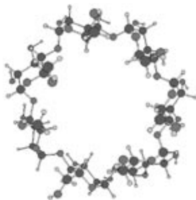
Figura 11. Representación esquemática de la \beta -ciclodextrina, en la que se muestra la estructura cíclica hueca.
