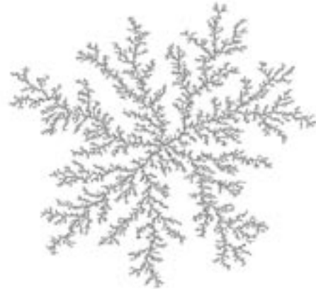
Figura 17. Corrida del modelo de DLA con malla hexagonal de 10,000 \times 10,000 con una semilla colocada en el centro y a la cual se le agregaron 30,000 trímeros. La dimensión fractal obtenida fue de 1.547.
