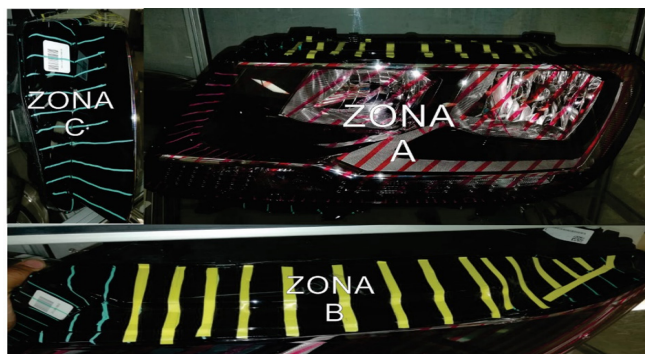
Figura 3. Identificación de partes del lente para identificar los defectos. (Manual de Tecnología de Iluminación Automotriz, 2016, p.11).
