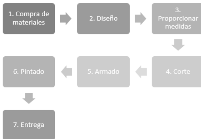
Esquema 9 Proceso de producción de productos de herrería
