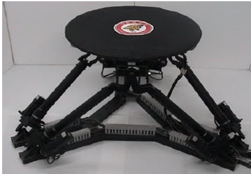
Figura 1: Mecanismo de un Robot paralelo
