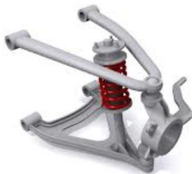
Fig. 3. Amortiguador en la suspensión.
