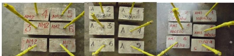
Fig. 3. Cubos para revisión de adherencia
