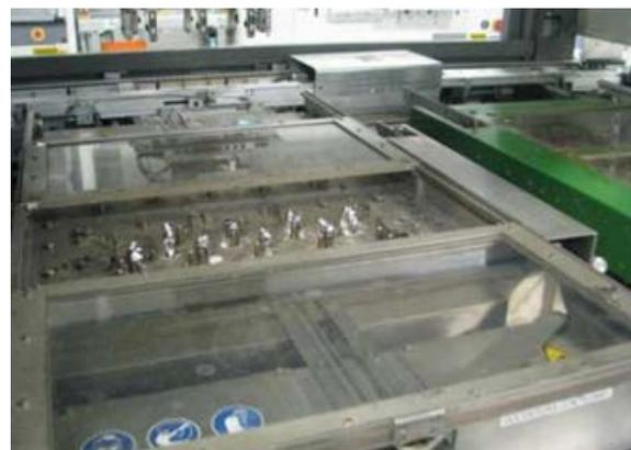
Fig. 5. Contenedor de soldadura con boquillas
