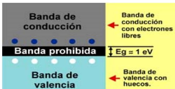
Fig. 3. Bandas de energía en semiconductores
