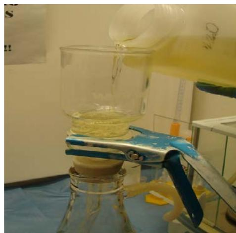
Fig. 8. Matraces unidos por las pinzas y vaciado de aceite
