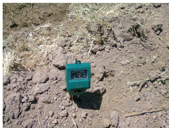
Fig. 18. Medición con Higrómetro.
