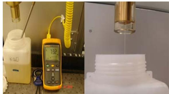
Fig. 11. Prueba de viscosidad mediante Copa Viscor 1487
