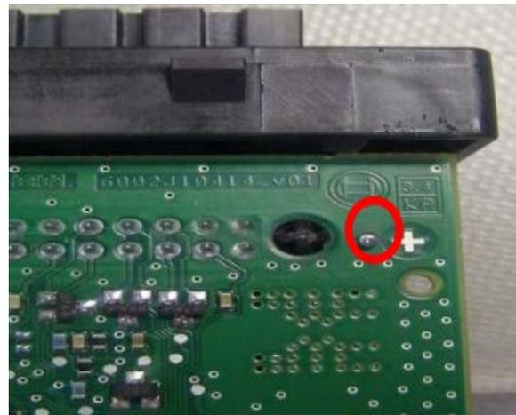
Fig. 18. Perla de soldadura en PCB
