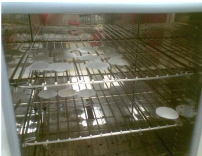
Fig. 9. Secado de filtros en horno
