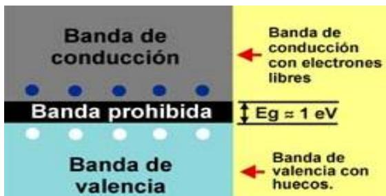
Fig. 3. Bandas de energía en semiconductores
