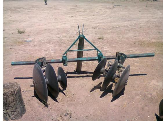
Fig. 11. Máquina para levantar bordos.
