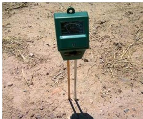
Fig. 15. Medidor de pH en uso.
