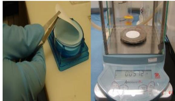
Fig. 7. Filtro tomado con pinzas y pesado en báscula
