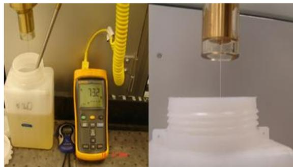
Fig. 11. Prueba de viscosidad mediante Copa Viscor 1487
