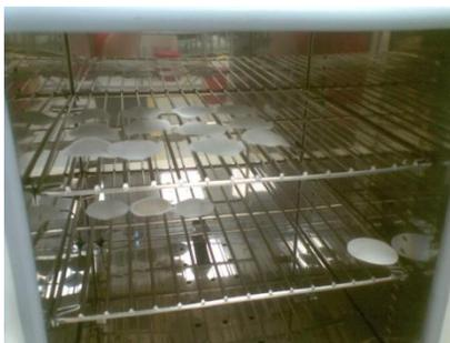
Fig. 9. Secado de filtros en horno
