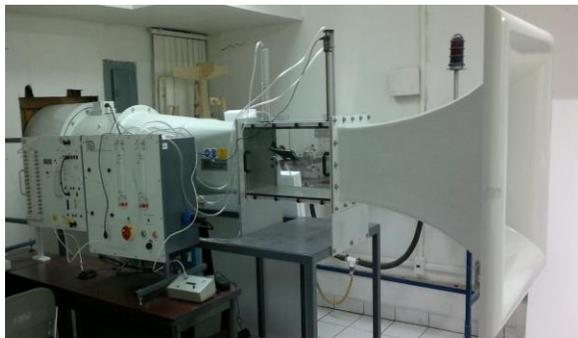
Fig. 2. Túnel de viento AF 100.
