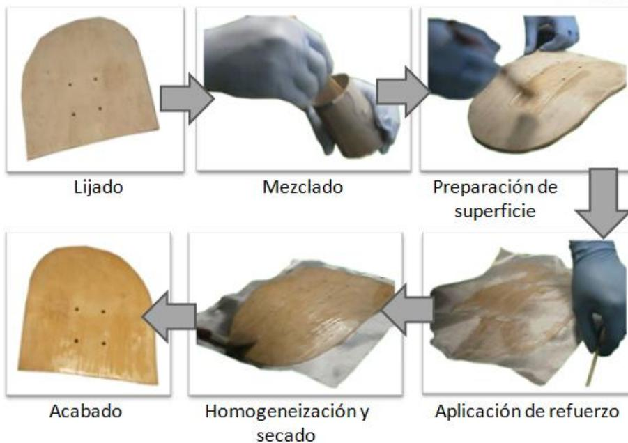
Figura 15: Método de reforzo para las tablas de patinar.
