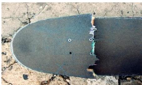
Figura 10: Fractura por eje
