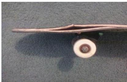
Figura 9: Delaminación de un tabla
