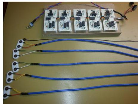
Figura 2. Sistema de 5 canales de adquisición de señales EMG
