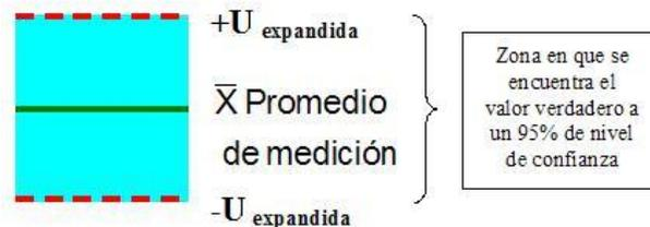
Figura 7. Representación gráfica del resultado de una medición
