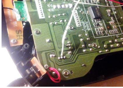
Figura 7. Salida del DAC conectada a la terminal de salida del potenciómetro en el radio control.
