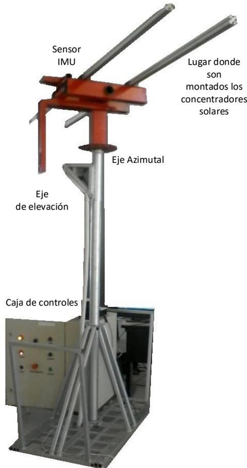
Figura 9. Prototipo de sistema de seguimiento Solar 2D.
