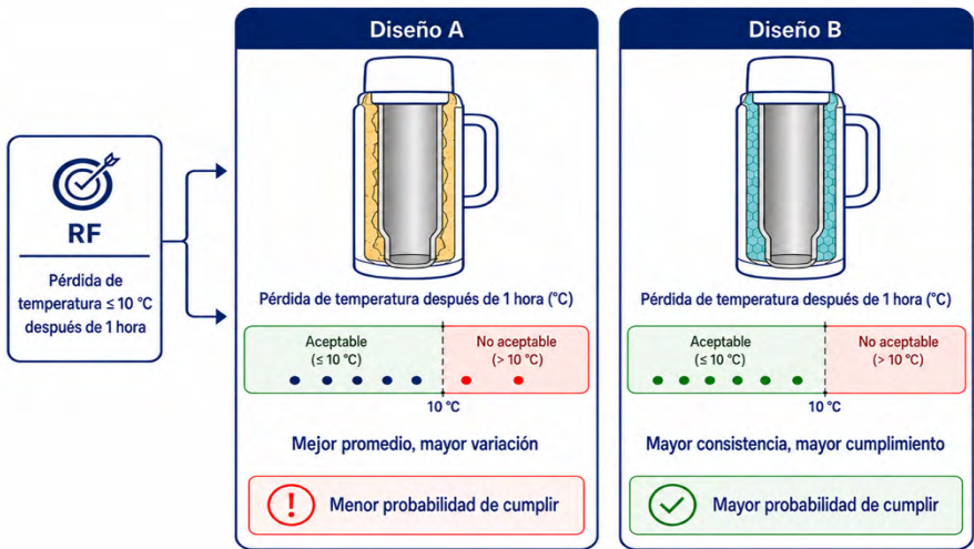
Figura 7. Comparación de dos alternativas de aislamiento según su probabilidad de satisfacer el requisito funcional relacionado con la pérdida de temperatura. Fuente: elaboración propia con base en [9], [10].
