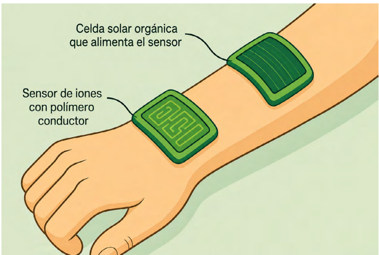
Figura 1. Ejemplo de un dispositivo vestible basado en materiales orgánicos: un sensor de iones con polímero conductor integrado con una celda solar orgánica para su alimentación.
