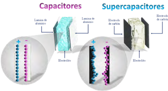
Figura 2. Esquema comparativo entre un capacitor electrolítico y un supercapacitor, detallando la diferencia en la estructura de los electrodos y su influencia en la adsorción de iones.
