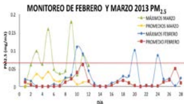
Figura 5. Valores máximos y promedios de MP_{2.5} del periodo febrero-marzo de 2013 en zonas del sureste de Ciudad Juárez, Chihuahua, medidos con el aparato DustTrak™ II y DRX aerosol monitor modelos 8530 y 8533.
